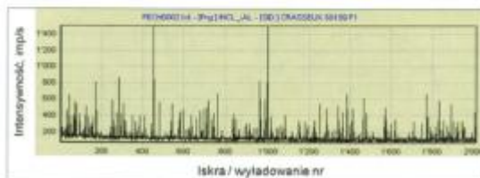
Rys. 15. Rozkład wartości intensywności O dla stopu B – duża liczba wtrąceń w osnowie
